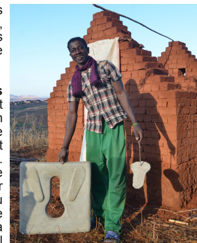
Des promoteurs construisent une dalle de latrine dans le village de Chikompulazi, Mzuzu, Malawi. Photo: WaterAid/Ernest Randriarimalala.
