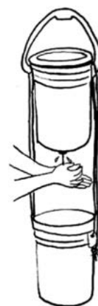
Figura 14: Tap Up – um lavatório com dois baldes . Imagem: Lippincott (2011), CERN Open Hardware Licence
