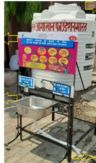
Figura 19: Ponto de lavagem das mãos accionado a pedal com um grande depósito de água. Foto: Fundação Aga Khan, Índia
