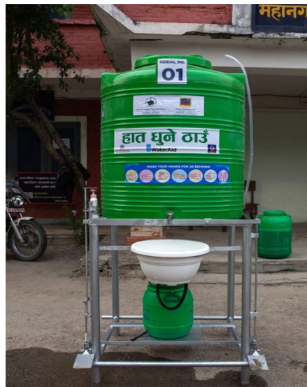
Figura 18: Ponto de lavagem das mãos accionado a pedal com um grande depósito de água. Foto: WaterAid Nepal
