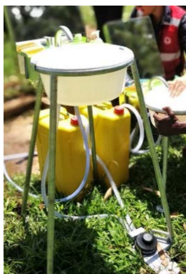
Figure 27 : Jengu relié à des jerrycans remplis d'eau ; variantes d'un dispositif de lavage des mains Jengu (de gauche à droite : pour des personnes à mobilité réduite, des enfants et des adultes) Crédit : G. Rose, Croix-Rouge britannique ; Arup
