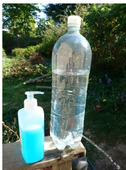
*Figura 16: jacto de água para lavagem das mãos controlado pela tampa. Foto: M. Coultas (2020)*
