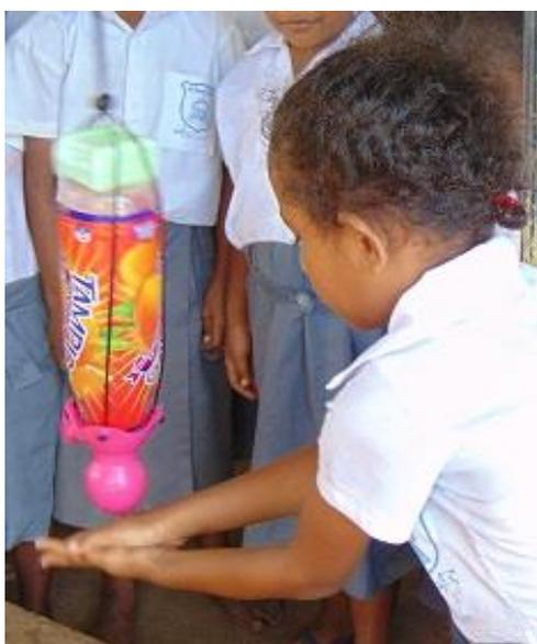
*Figure 15: Lavagem das mãos com sabão e uma torneira portátil SPATAP colocada numa garrafa de água. Foto: SPATAP (s. d.)*
