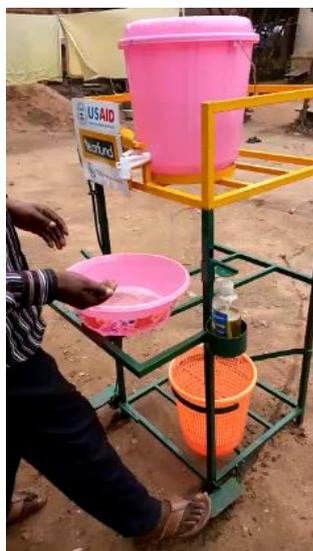
*Figura 11: Ponto de lavagem das mãos accionado a pedal. Foto: Tearfund DRC*
