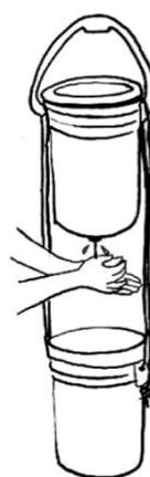
Figura 6: Tap Up – um lavatório com dois baldes. Imagem: Lippincott (2011), CERN Open Hardware Licence
